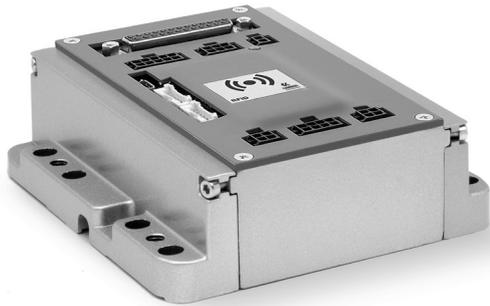
Gli azionamenti Serie DRCS, compatti e ottimizzati in una taglia unica, possono controllare tutti i motori Stepper Camozzi a 2 fasi con avanzamento a micro stepping. L'uso della tecnologia micro stepping (fino a 1/16 di step) ha permesso di avere una corrente quasi sinusoidale riducendo sensibilmente la risonanza naturale del motore stesso.
