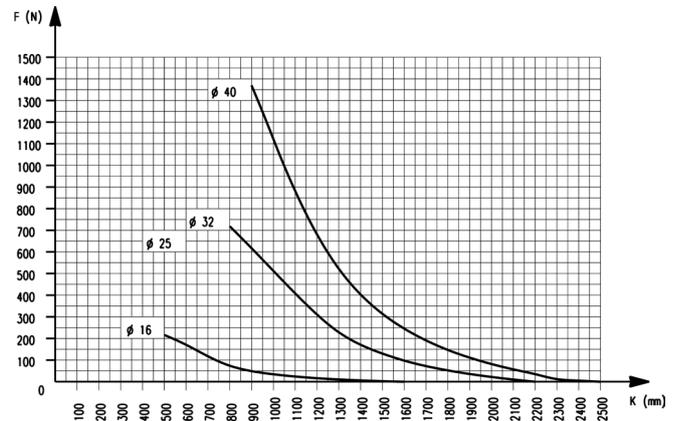
N.B.: Il diagramma è stato ricavato in funzione di una freccia Max di 0,5 mm.
