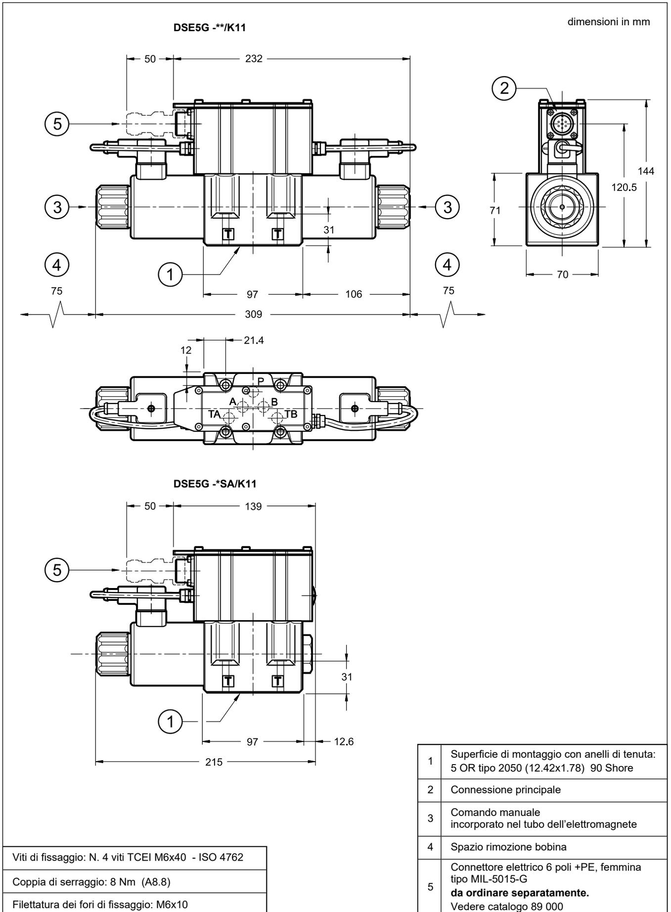
9 - DSE5GL - DIMENSIONI DI INGOMBRO E DI INSTALLAZIONE
