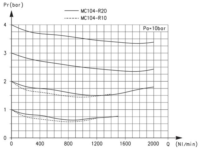
Diagramma di portata per i modelli: MC104-R10 e MC104-R20
