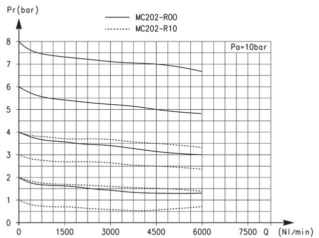
Diagramma di portata per i modelli: MC202-R00 e MC202-R10
