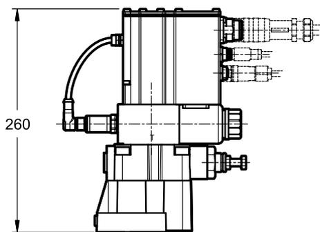
**NOTA 1:** Al primo avviamento o dopo un lungo periodo di non utilizzo, occorre spurgare l'aria tramite lo sfiato (2) presente nella parte terminale del tubo solenoide.
