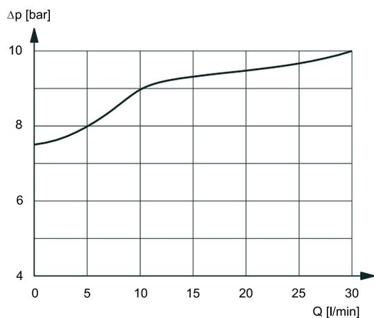
Perdite di carico con flusso A → T attraverso il compensatore.
