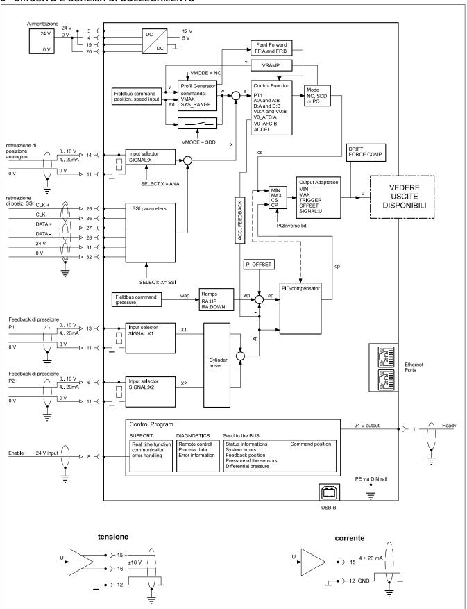
**NOTA:** Se la scheda è configurata per il controllo di posizione semplice senza limitazione dipressione, il valore di uscita viene calcolato a partire dal valore in uscita del controller di posizione (CS) anziché applicare i parametri MIN e MAX.
