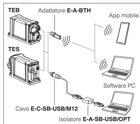
**ATTENZIONE:** la porta USB dei driver non è isolata! Per il cavo E-C-SB-USB/M12, si raccomanda di utilizzare l'adattatore dell'isolatore E-A-SB-USB/OPT per la protezione del PC
