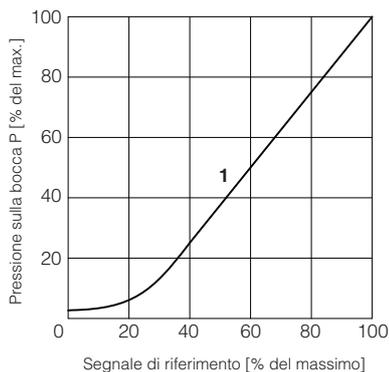
**2 Diagrammi pressione/portata** con segnale di riferimento impostato su  $Q = 1$  l/min
