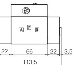
**12 DIMENSIONI DI INSTALLAZIONE DI DLPX(S) [mm]**
